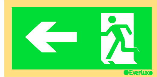
07 PLACA DE SINALIZAÇÃO INDICAÇÃO DO SENTIDO (ESQUERDA OU DIREITA) DE UMA SAÍDA DE EMERGÊNCIA - CÓDIGO 13 (NBR 13434-2:2004) S/ ESCALA
