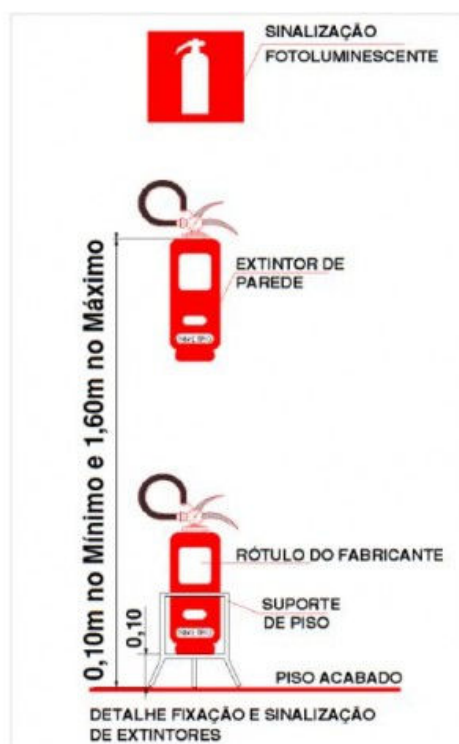
Fig. 02 – Detalhes fixação extintores
