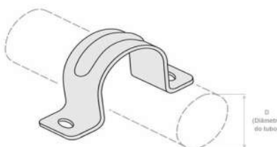
Detalhe Abraçadeira tipo “U”
