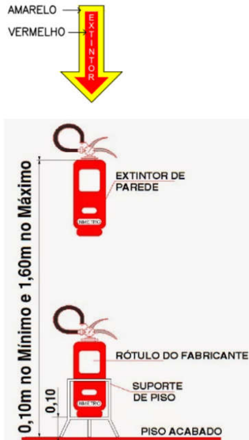
Fig. 02 – Detalhe fixação extintores
