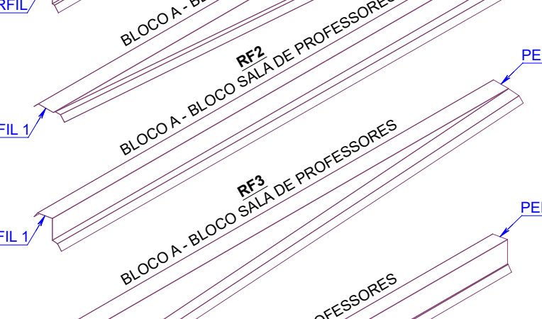
DETALHE PERFIL DOBRA RUFO DE TOPO PERSONALIZADO - RF3 INTERLIGAÇÃO BLOCO A - PARADA ÔNIBUS ESCALA 1:10
